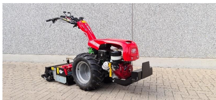
Fort 180 met ballonbanden, rotoleg MTL75 en gewichtdrager anti-vib met gewicht
