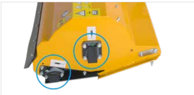
Goed toegankelijke lagerposities voor snel onderhoud
