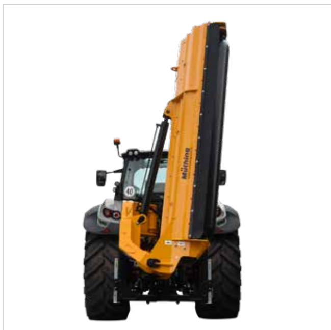
Uitgebreide afweerinrichting bij extreem hoog steengehalte ter bescherming van trekkers en dragende voertuigen
