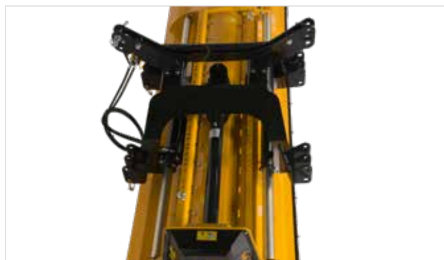
Hydraulische zijverstelling (1x DW vereist) MU-L 180 - 280 Vario: 56 cm hefhoogte
