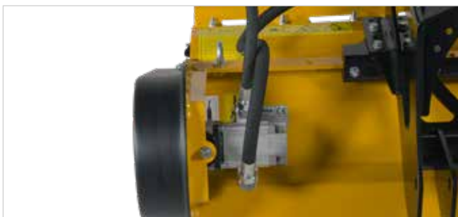
Stabiele, groot uitgevoerde en in hoogte verstelbare steunwielen, 360° zwenkbaar (Ø ca. 235 mm hoog en ca. 80 mm breed)
