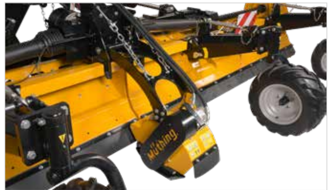
Hydraulisch aangedreven bermmulchmachine, voor perfecte aanblik en stabiel arbeidsresultaat Vereiste oliehoeveelheid: 50 l / 180 bar. Vereiste hydraulische aansluitingen: 1x drukleiding met stekker BG 2 1x drukloze retourleiding met mof BG 3, max. tegendruk < 20 bar
