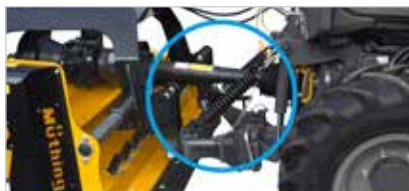
Verbeterde wendbaarheid en tractie bij frontaanbouw door de veerontlasting aan de voorkant (optioneel)
