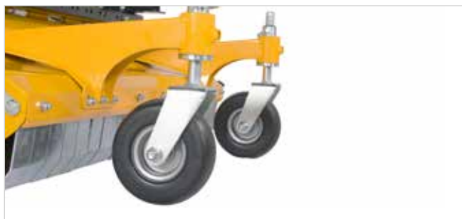
Stabiele, groot uitgevoerde en in hoogte verstelbare steunwielen, 360° zwenkbaar (Ø ca. 235 mm hoog en ca. 80 mm breed)
