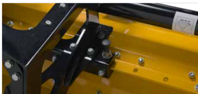
Met mechanische zijverschuiving: MU-E 120 - 140 Vario: 20 cm; MU-E 160 - 200 Vario: 25 cm
