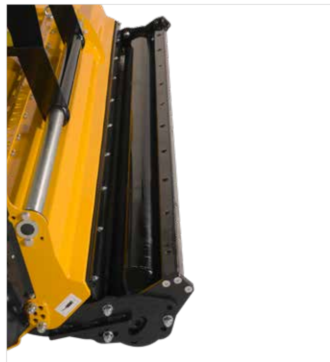
Afstrijker voor verschoven looprol incl. verlengde zijplaten voor de looprol
