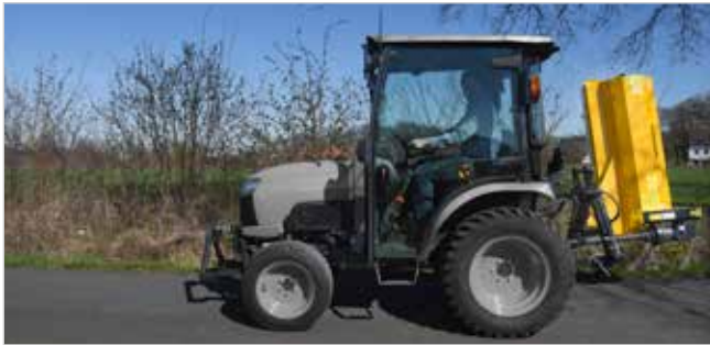
Kort model zodat het zwaartepunt dicht bij de trekker ligt
