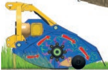
Scarico posteriore al rullo The cut material is distributed over the top of the roller Ablage nach der Laufwalze, weniger Kraftbedarf Descarga detrás del rodillo Évacuation à l'arrière du rouleau
